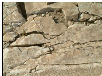
Ετοιμόρροπα θραύσματα που ορίζονται από ρωγμή
