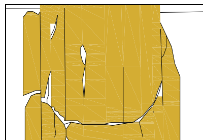
Σχεδιαστική απόδοση μεγάλων ή μικρών κενών – αρμών που προκύπτουν μετά τις συγκολλήσεις θραυσμάτων
