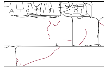
Σχεδιαστική απόδοση επιφανειακών ρωγμών
