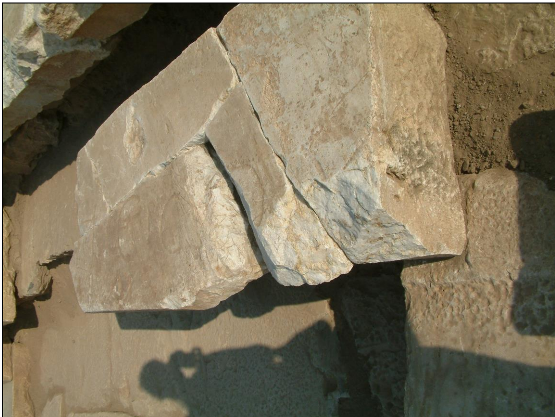
Μεγάλα και μικρότερα κενά (αρμοί συγκόλλησης) που έχουν προκύψει μετά την συγκόλληση θραυσμάτων, εξαιτίας της απώλειας μάζας
